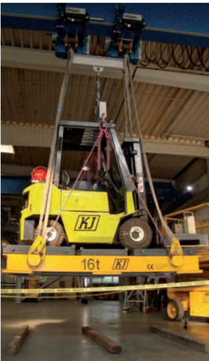
Dieser Gabelstapler samt Palette mit einem Gewicht von 8.100 Ki- logramm ist an einen Bolzen geklebt: mit handelsüblichem Sekun- denklebstoff.
