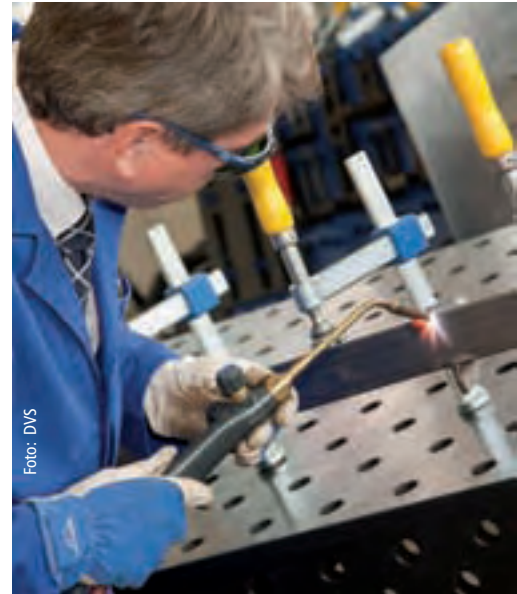
Beim Flammrichten wird das zu verformende Bauteil an bestimmten Bereichen stark erwärmt. Der Prozess erfordert viel Erfahrung und Gespür für die richtigen Ansatzpunkte.
